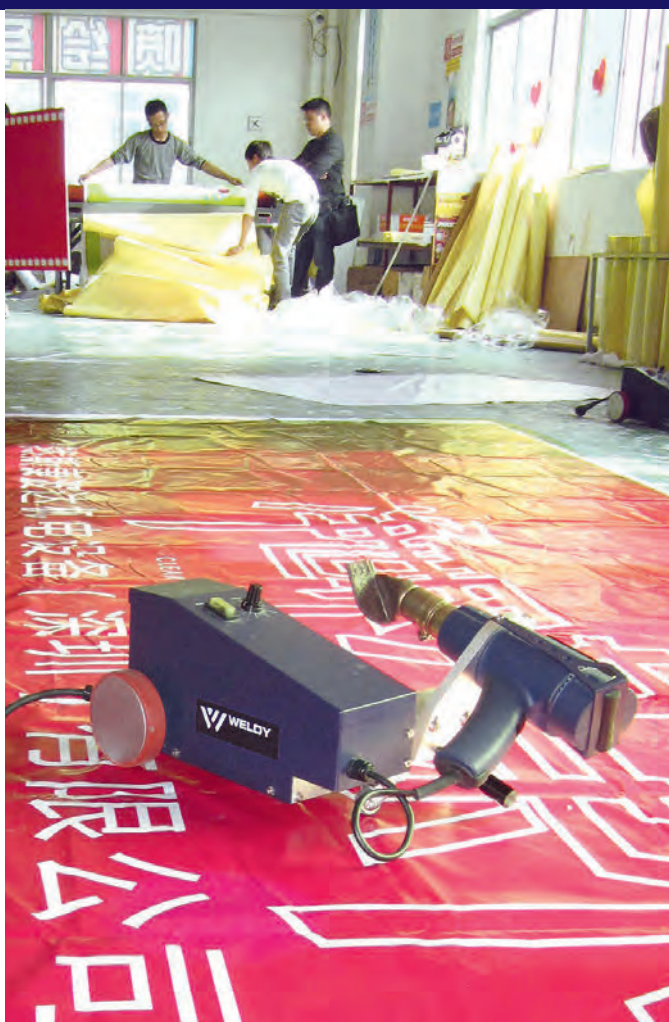
123.627 Насадка для foiler на шов 20 мм
