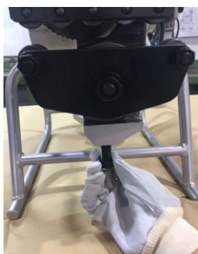
Рисунок 9: Поднимите или опустите угловое устройство, повернув нижний стопорный винт, глядя на шкалу. (Следующая картинка)
