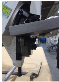
Рисунок 13: Поднимите заготовку, пока она не коснется верхних роликов.
