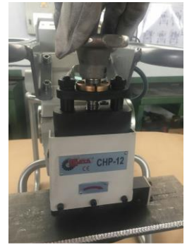
Рисунок 14: Опустите роликовое устройство, повернув маховик
