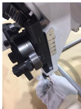
Рисунок 10 и 11: Поместите нониус в нужное положение градуированной шкалы (в зависимости от толщины листа), чтобы получить максимальную фаску, которую фаскосниматель может производить за один проход.
