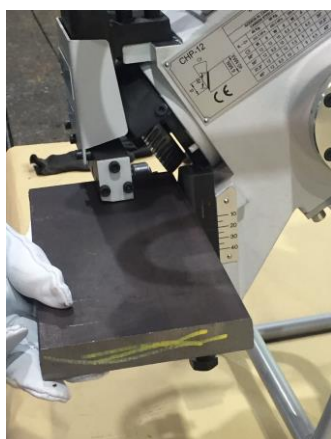
Рис. 20 и 21: Поместите заготовку с правой стороны (вид спереди) фаскоснимателя, убедившись, что она касается вертикальной направляющей № 10-09 (или, в случае длинных листов, установите машину с левой стороны листа )
