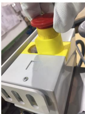
Рисунок 2: Запуск, Аварийная кнопка
