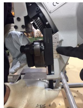
Рисунок 10 и 11: Поместите нониус в нужное положение градуированной шкалы (в зависимости от толщины листа), чтобы получить максимальную фаску, которую фаскосниматель может производить за один проход.
