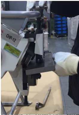
Рисунок 12: Поместите заготовку в свободное пространство между опорными роликами и угловым устройством.
