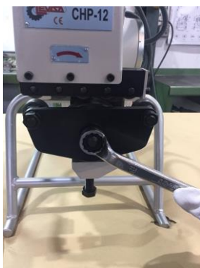
Рисунок 7: Ослабьте центральный винт, который удерживает угловое устройство
