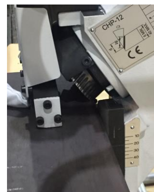
Рис. 22, 23 and 24: Прижимайте заготовку к фрезе до тех пор, пока материал не начнет поступать и автоматически продвигаться, вследствие снятия фаски
