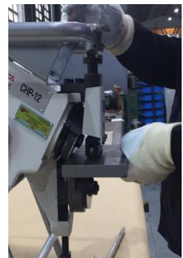
Image 17: Станок теперь правильно настроен. Удалите заготовку.
