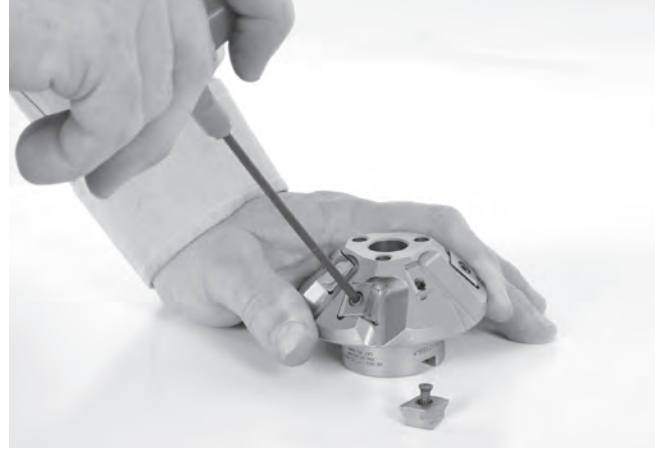
Şekil 24 – Kesici Bagaların Değiştirilmesi
