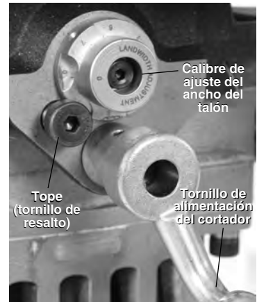
Figura 18 – Fijación del calibre de ajuste del ancho del talón
