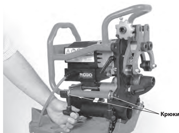
Рис. 9 – Крепление станка для снятия фаски к держателю
