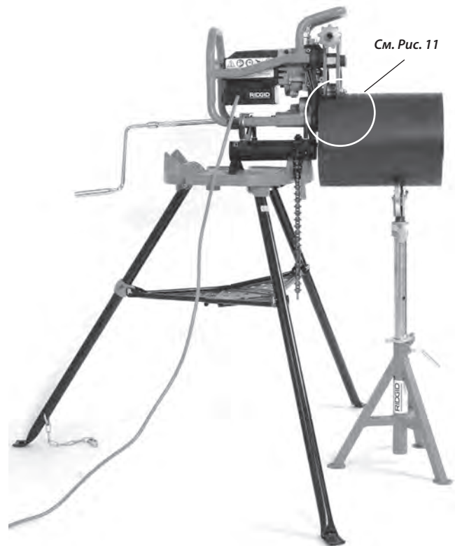
Рис. 12 – Закрепленный станок для снятия фаски, короткая труба, одна опора для трубы
