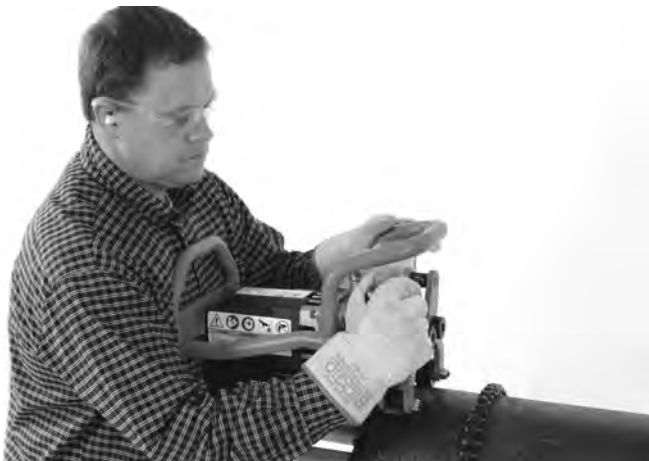
Figure 17A – Serrer la vis de blocage manuellement
