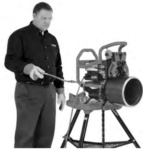
Figura 20C – Operación de biselado (biseladora fija/tubo en rotación)
