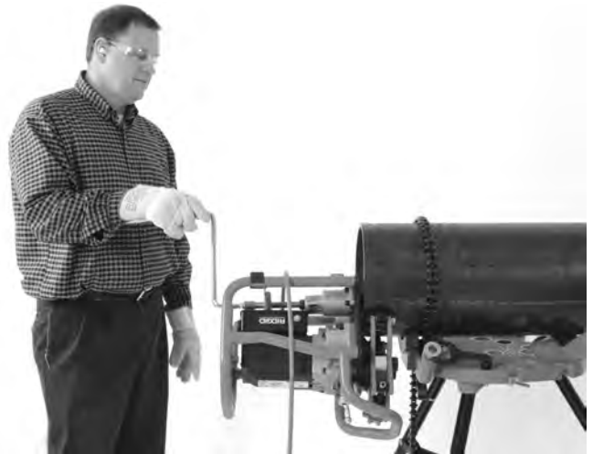
Figure 20B – Biseautage en cours (pièce fixe/machine mobile)
