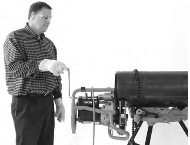
Figura 20B – Operación de biselado (pieza fija/biseladora móvil)
