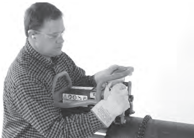
Рис. 17А – Затягивание зажимного винта от руки
