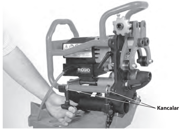
Şekil 9 – Pahlama Makinesinin Adaptöre Tespit Edilmesi
