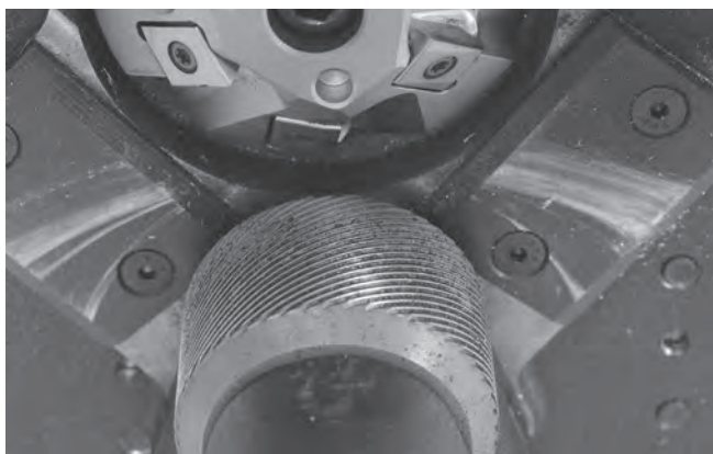
Рис. 22 – Чистые насечки ведущего ролика
