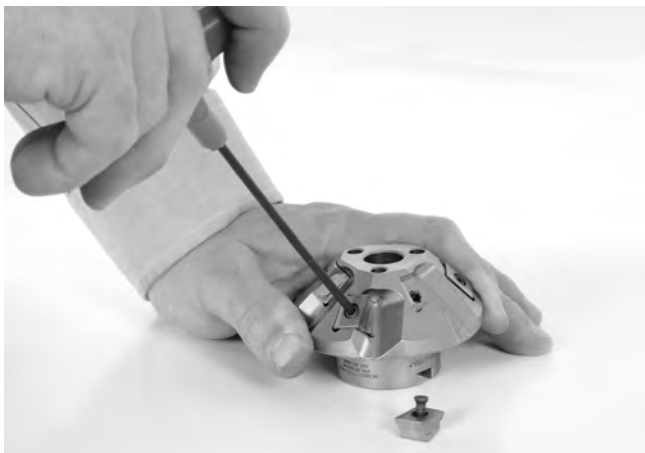
Figure 24 – Remplacement des couteaux
