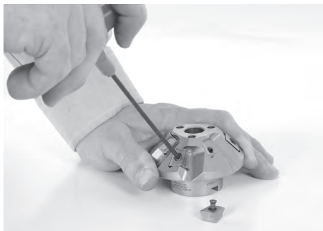
Рис. 24 – Замена вставных резцов
